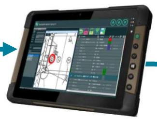
服务器推送检测计划到执行端，2D/3D 图纸测量引导
